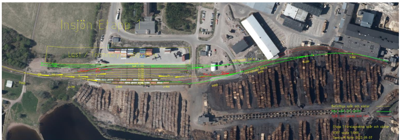
Figur 6.9. Planskiss järnväg. Befintliga spår och växlar i gult, nya spår och växlar i grönt, spår och växlar som ska rivas i rött.
