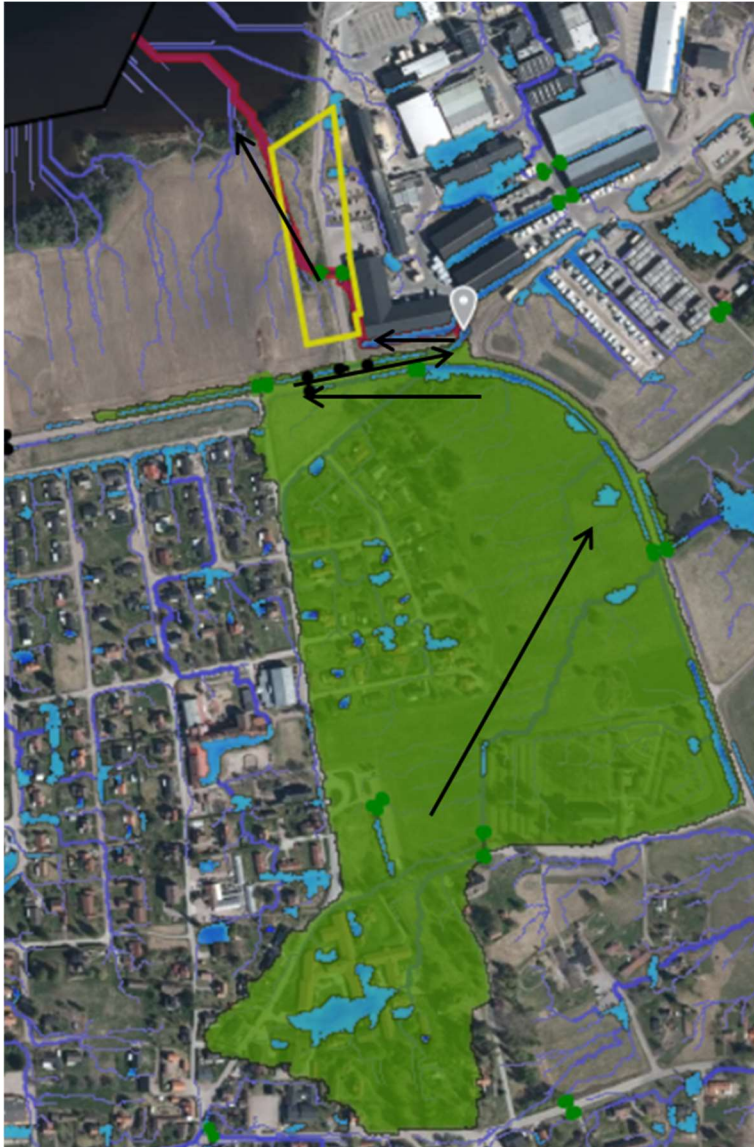
Figur 8. Avrinningsområde som avrinner till och inom område A (som är markerat med gul polygon) De svarta pilarna visar den generella flödesriktningen.
