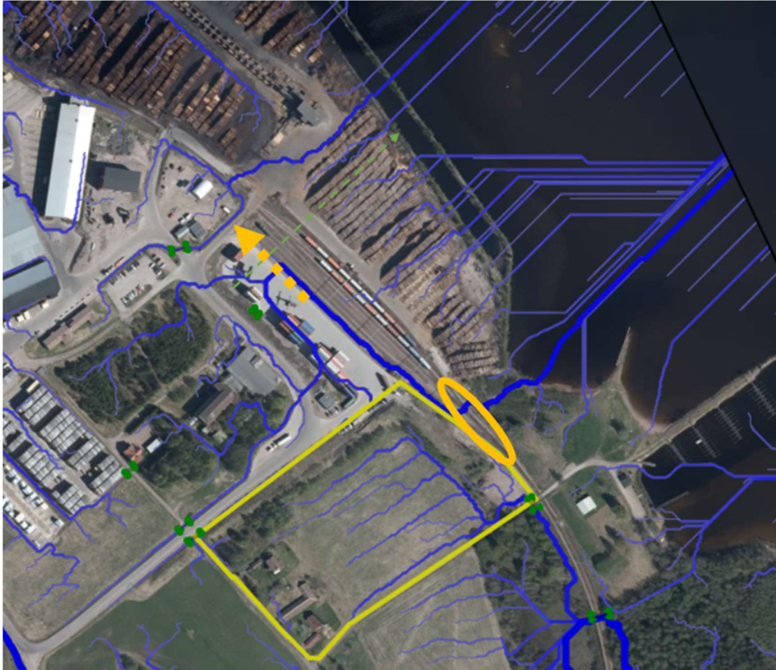
Figur 31. Befintliga skyfallsvägar visas med blåa linjer. Område B markerat med gul polygon. Vide den orange cirkeln kan en trumma anläggas under järnvägen för att skydda denna från skyfall. Alternativt så kan höjdsättningen ändras för att avleda skyfall åt nordost, likt den orange pilens markering.
